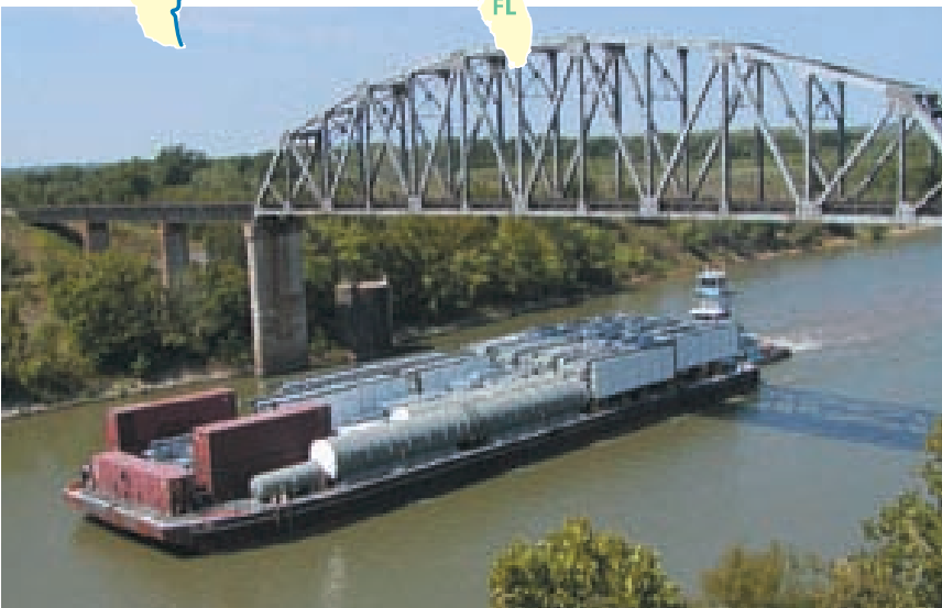
Two (2) GE Frame 6B HRSG Units in transit to Montego Bay, Jamaica
